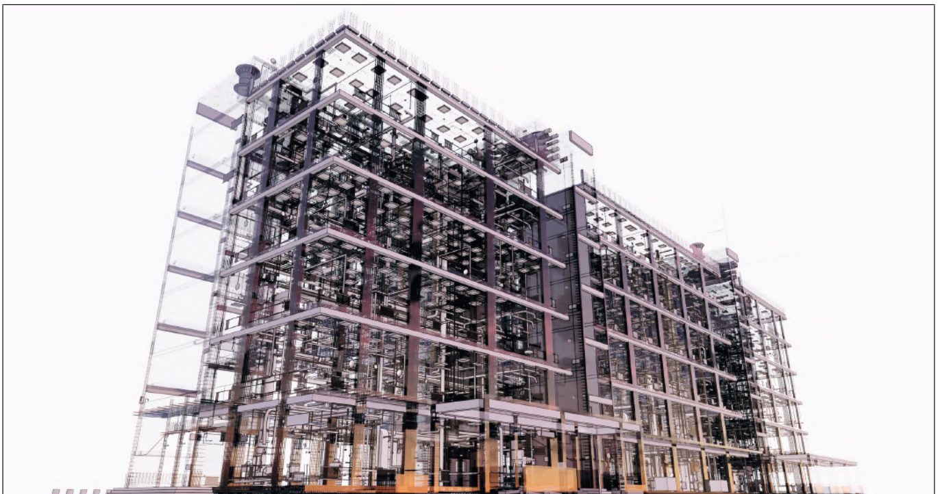
Bild 11: Visualisering av en BIM-modell utifrån en kontorsbyggnad (utan yttre skal)
