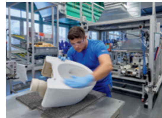
Montering av duschtoaletter...
